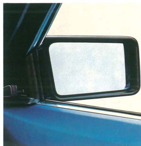
Miroir extérieur réglable de l'intérieur du côté passager.
