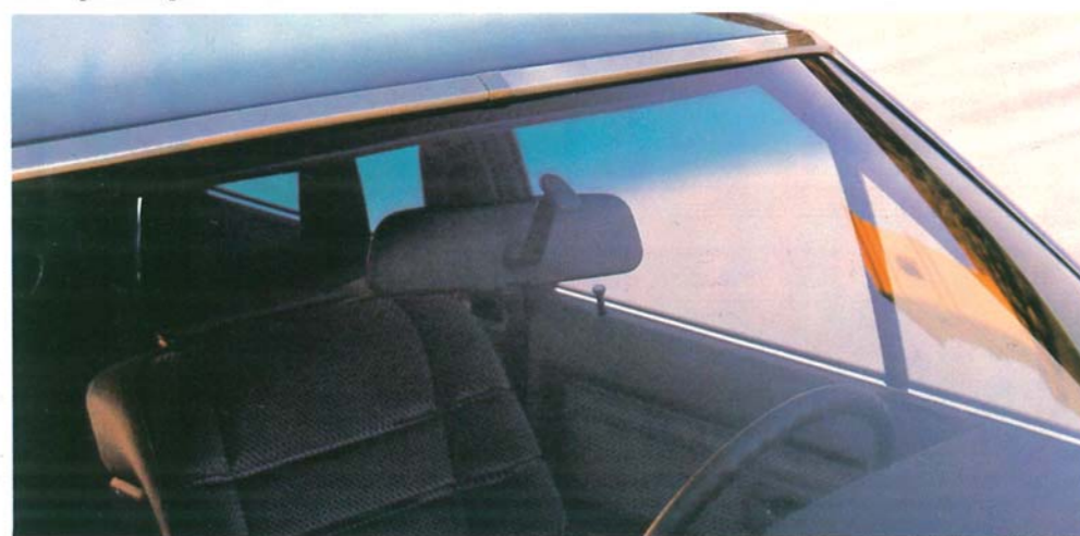
Pare-brise en verre laminé avec bande colorée.
